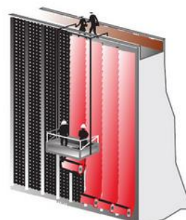
5 – installation de la géomembrane
