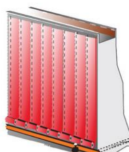
7 – Mise en œuvre et raccordement du système de collecte des drains
