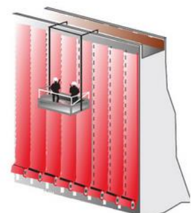
6 – Fixation de la géomembrane
