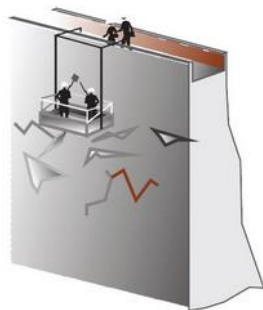
2 – Préparation de la surface
