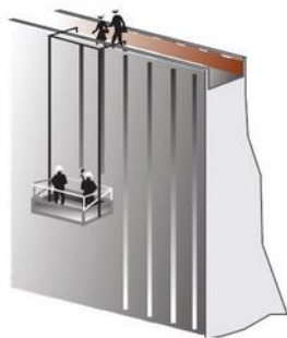
3 – installation d'un ancrage vertical
